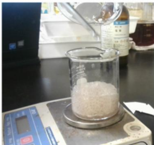
写真1 アコヤガイ粉末に希塩酸を加えた様子
