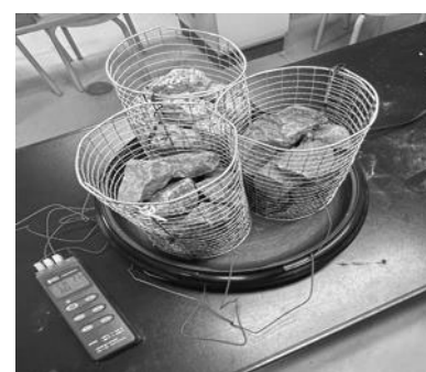
図10 熱伝導率の測定の様子
