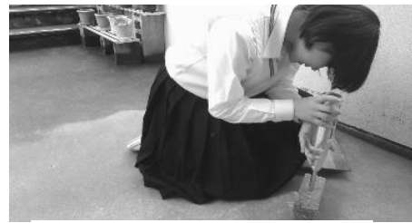
図3 反発度測定の様子
