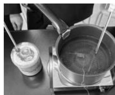
図9 比熱の測定の様子
