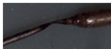
図4 液面付近が溶けた銅線
