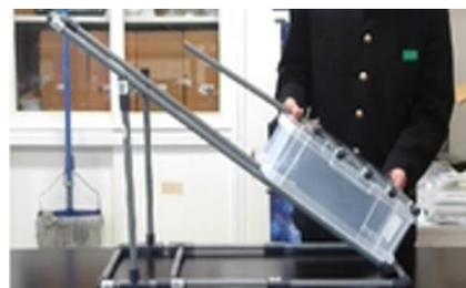
図2 実験装置（傾斜台）
