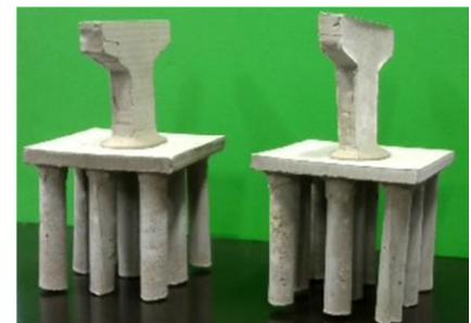
図4 自作の橋脚模型
