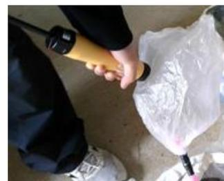
図 3 気体検知管測定
