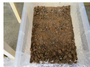
図 4 勾配 16° 散水量 60mm/h の様子
