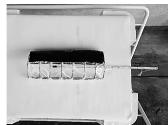
図4 相補型の温度の測定装置
