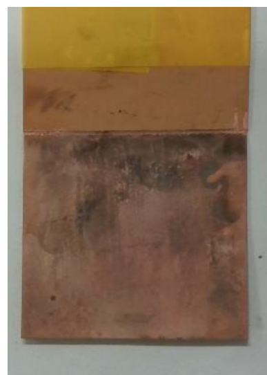
図 13 ビニールテープを巻いた銅板の形状の変化
