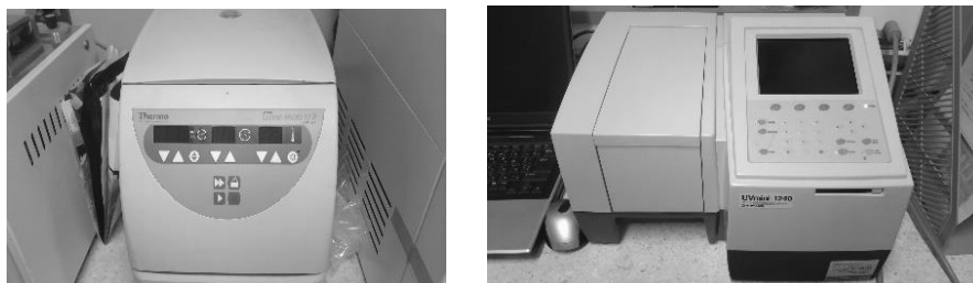
図4 遠心分離機と可視紫外分光光度計 左: LEGEND MICRO 17R 右: UV-mini1240
