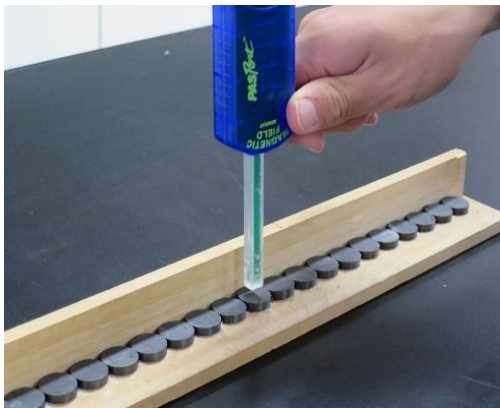
写真4:磁気センサーで磁力を測る
