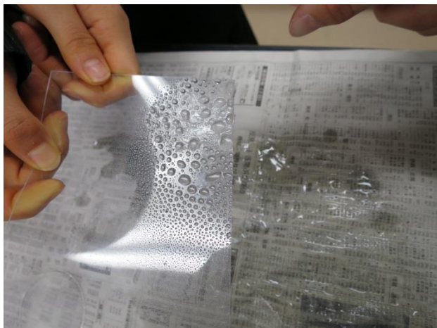
写真2: TiO 2 の超親水性の確認実験
