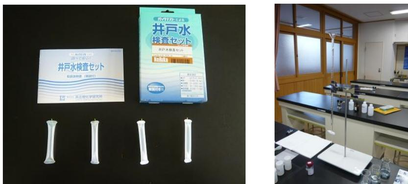
写真1 (左)パケットテスト (右)EDTAの実験器具
