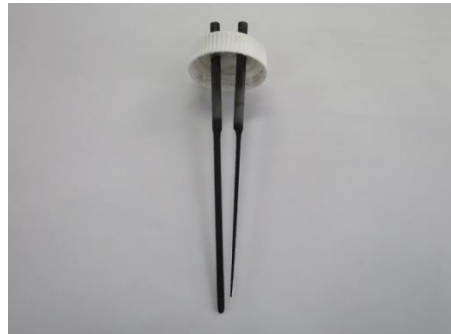
写真5：実験後の炭素棒 （左：負極 右：正極）
