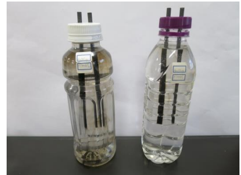
写真1：実験に用いた簡易型の燃料電池(左：Na 2 CO 3 aq 右：NaOHaq)
