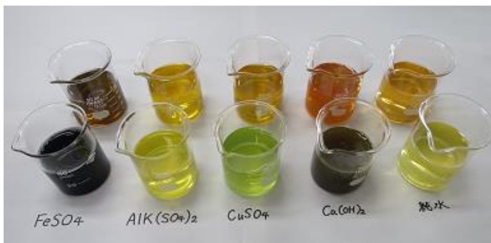
Fig.2 媒染剤を加えた抽出液の例
