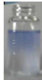
写真 7 : 河川水と海水の重層実験 (上層が海水で下層が河川水)
