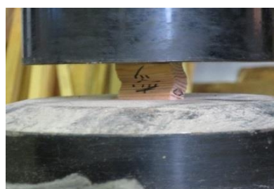
写真2 木材の強度測定
