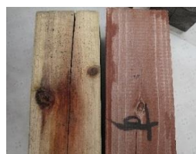
写真3 スギ (左: スギ屋上) (右: スギ防腐剤)
