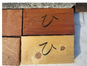
写真1 ヒノキ (上段: ヒノキ防腐剤) (下段: ヒノキ)
