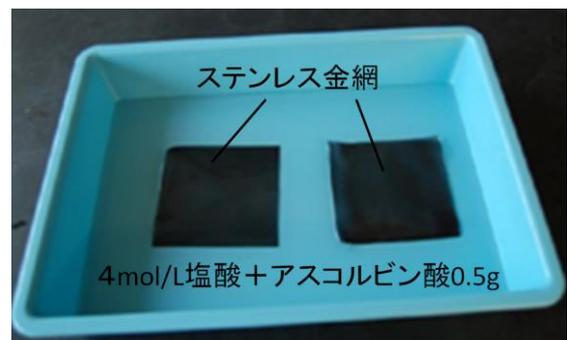
図2 不動態被膜の処理
