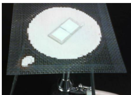
図1-a 導電膜の塗布と焼付け
