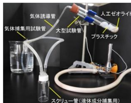
図5 プラスチックの熱分解装置
