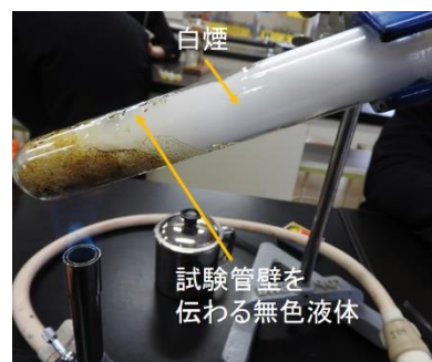
図7 ポリスチレンの熱分解の様子
