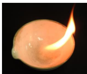
図 13 分解生成物の燃焼
