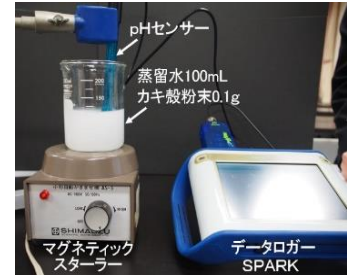
図4 pH 変化の測定
