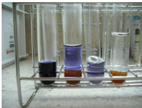
図7 イオン交換樹脂の吸着による検証結果 左2本；グリシン溶液 右2本；ゼラチン+ハチミツ溶液
