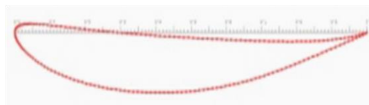
図3：上下逆の翼の断面図
