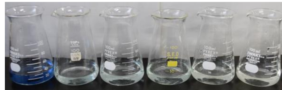
図7：モリブデンプルー法による色の変化
