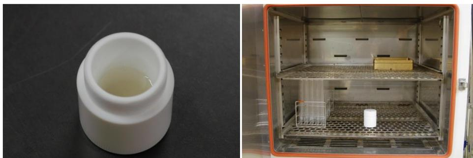
図3：水熱合成の様子（左：耐熱容器 右：恒温槽）
