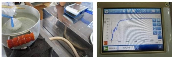
写真 1 : スパークによるパック内の温度計測
