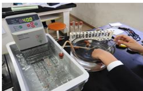
図2 水上置換法による酸素発生量の計測
