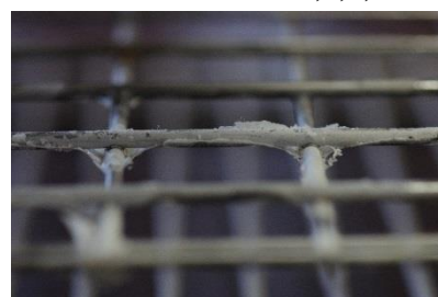
図3 降雨実験後のニス未塗布下部にできた析出物
