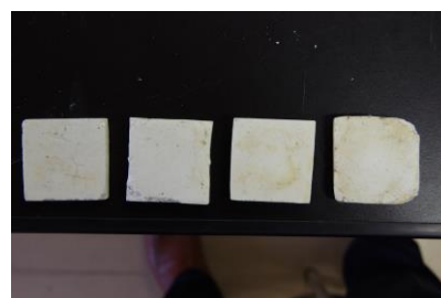
図2 耐水性試験後の試料 (右からニス塗布 0,1,2,4回)
