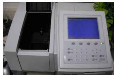
図 6 島津紫外可視分光光度計 UVmini-1240
