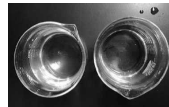
図6 水槽水(左)とMP除去後の水(右)
