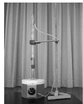
図2 ホロセルロース処理の様子
