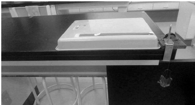
図 4 最大摩擦力の測定装置
