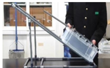
図2 実験装置（傾斜台）
