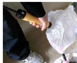
図 3 気体検知管測定
