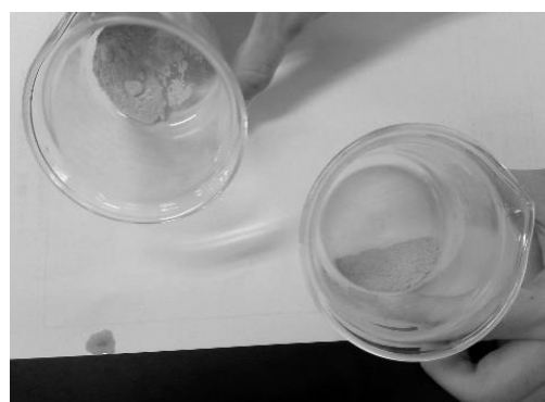
図2 粉末化したみかん果皮 左：蒸留水処理＋アルカリ処理 右：アルカリ処理
